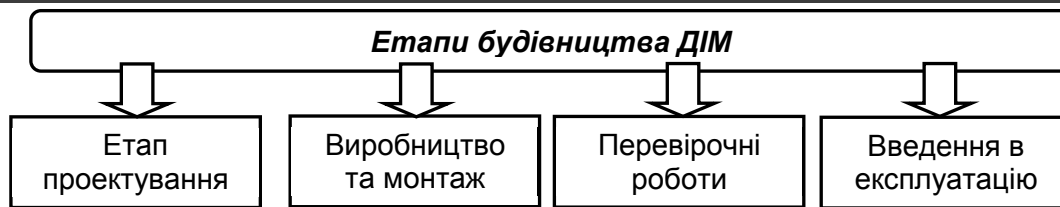
Рис. 1. Схема основних етапів будівництва ДІМ
